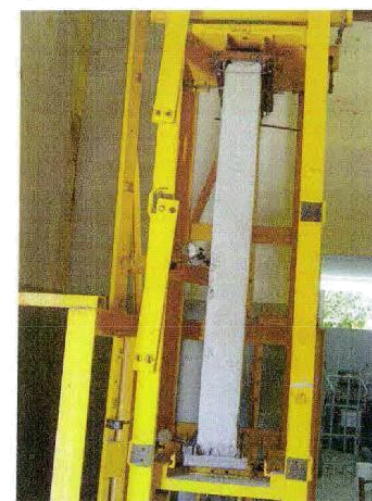
Figura 5 – Aspecto de um segmento de parede preparado para ensaios de compressão.
