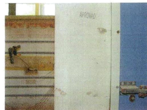
Figura 17 – Detalhe das fissuras observadas durante ensaio de exposição a altas temperaturas.
