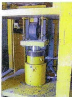
Figura 6 – Mecanismo de aplicação de carga.
